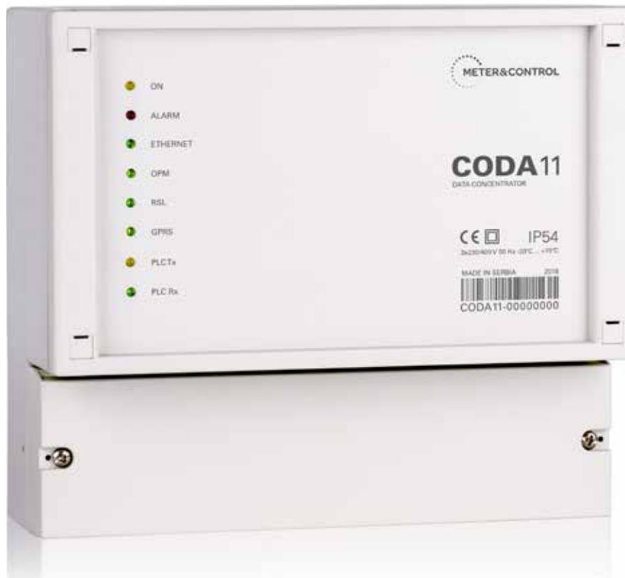
CODA11 je koncentrator podataka koji omogućava komunikaciju između AMI centra i električnih brojila. Komunikacija između koncentratora i brojila se odvija po PLC mreži (S-FSK ili G3-PLC), dok se komunikacija između koncentratora i AMI centra odvija preko GPRS/3G mreže ili Ethernet porta (TCP/IP). CODA11 omogućava očitavanje i parametrizaciju brojila i upravljanje potrošnjom, automatski po zadatom rasporedu ili na
